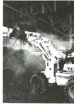
堆肥の切りかえ作業
