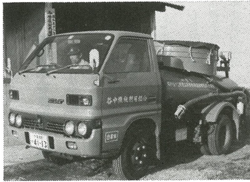
▶畜産公害対策の一環として導入されたバキュームカー
