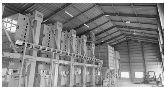
▲ ライスセンター内の大型乾燥機械
