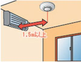
◀エアコンの吹き出し口や換気口などの位置から1.5m以上離し、ストーブなどの熱の影響を直接受けないようにする。
