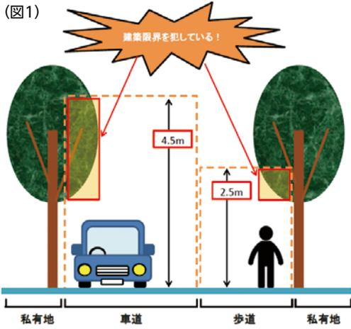
道路法第三十条および道路構造令第十二条では、道路上の安全な通行を確保するため、車道の上空4.5メートル、歩道の上空2.5メートル
